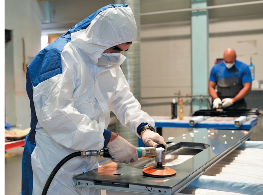
▲ Работник ПФ «КМТ» полирует створку двери для вагона локомотивной тяги в малярном цехе после нанесения жидкой окраски для передачи на сборку
